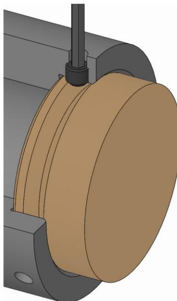
1. Desserrer les vis de serrage de la pièce interchangeable jusqu'à ce que la pièce interchangeable puisse être retirée.
