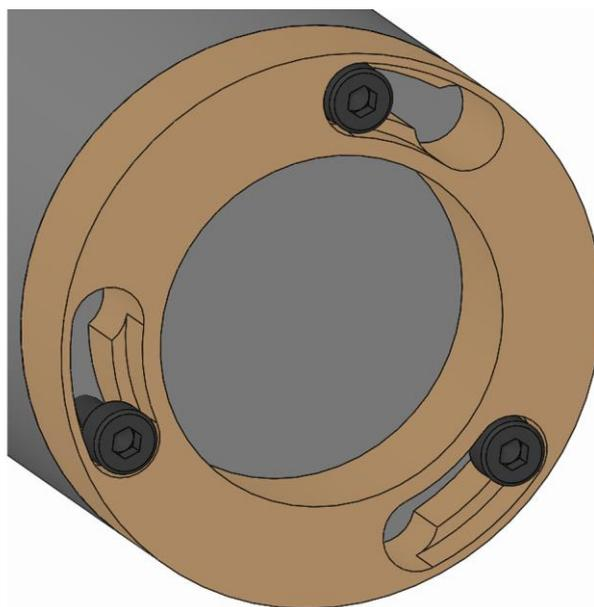
2. Tourner la pièce interchangeable de façon à ce que la tête de la vis de fixation de la pièce interchangeable passe par l'ouverture à baïonnette.
