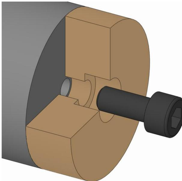
2. Serrer les vis de fixation de la pièce interchangeable et les serrer avec le couple de serrage prescrit [voir chapitre « Couples de serrage des vis »].
