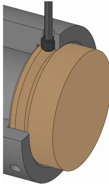
2. Serrer les vis de serrage de la pièce interchangeable et serrer avec le couple de serrage prescrit [voir marquage].
