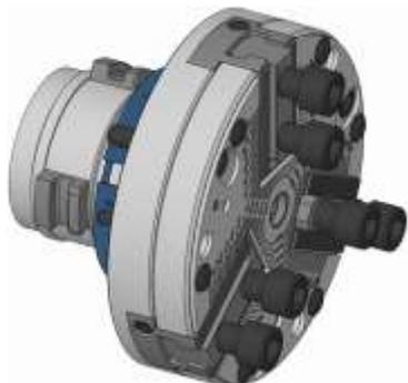
Le module en mors sert d'adaptation des moyens de serrage pour l'utilisation de mors de serrage. Ce dernier permet d'étendre la plage de serrage du diamètre du mandrin.
